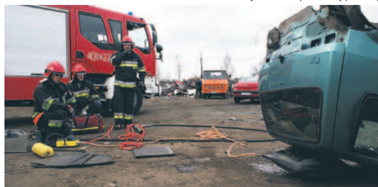
Do podniesienia samochodu użyto specjalnych poduszek napędzanych powietrzem pod wysokim ciśnieniem
