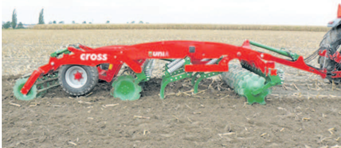
Jeden z aparatów służących do uprawy bezorkowej
