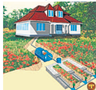
Przydomowa oczyszczalnia ścieków
