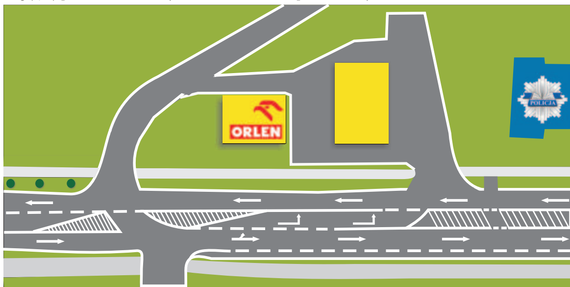
Jednym z elementów remontu ul. Piłsudskiego będzie wykonanie nowego oznakowania poziomego ulicy. W ten sposób zostaną wymalowane linie w okolicach policji oraz stacji paliw
